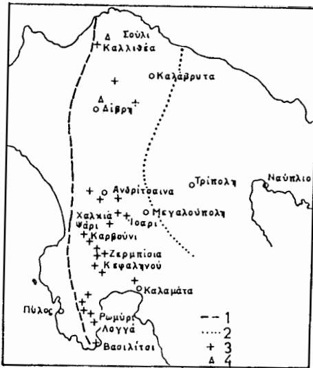
Σχ.2. Χάρτης εμφανίσεων μαγγανιούχων μεταλλευμάτων κρητιδικής ηλικίας (+) και βιτουμενιούχων (καυσίμων) σχιστολίθων του άνω Κρητιδικού (Δ).
