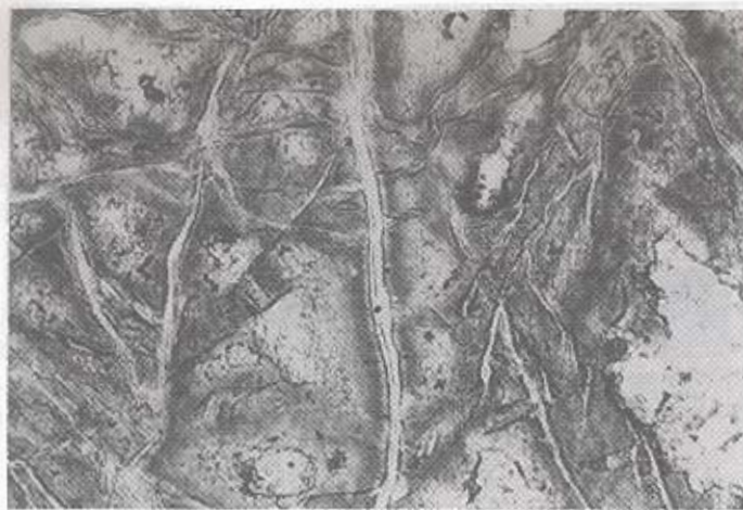
Σχ. 2: Λιζαρδίτης (λευκός), αντικαθίσταται από σκούρο πράσινο έως καφετί σιδηρούχο σερπεντίνη. Αποσθρωμένοι σερπεντινίτης της σαπρολιθικής ζώνης (δείγμα 23 στο σχ. 1). Διερχόμενο φως //Nicols X25.
