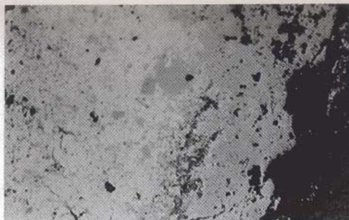
Σχ. 6: Πισσόλιθος. Το εσωτερικό του τμήμα αποτελείται, κατεξοχήν, από αιματίτη, ενώ η περιφέρειά του, από μαγνητίτη (δείγμα 18, σχ. 1). Ανακλώμενο φως, //Nicols, X200.
